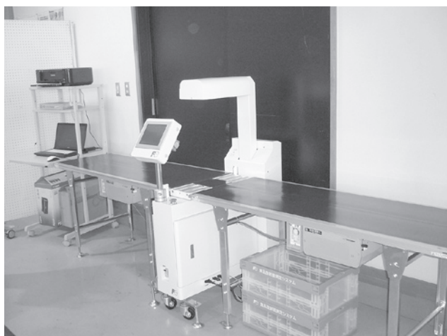
道の駅に導入された放射線量測定機器
