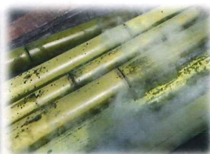
湿式法（湯晒し）による油抜き作業 竹の油分を除去
